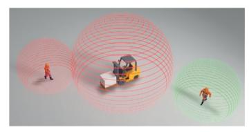
Sollte die Distanz zwischen Flurförderzeug und einer Person einen definierten Wert unterschreiten, wird die Fahrgeschwindigkeit des Staplers mithilfe des Assistenzsystems LOS3000 automatisch reduziert
